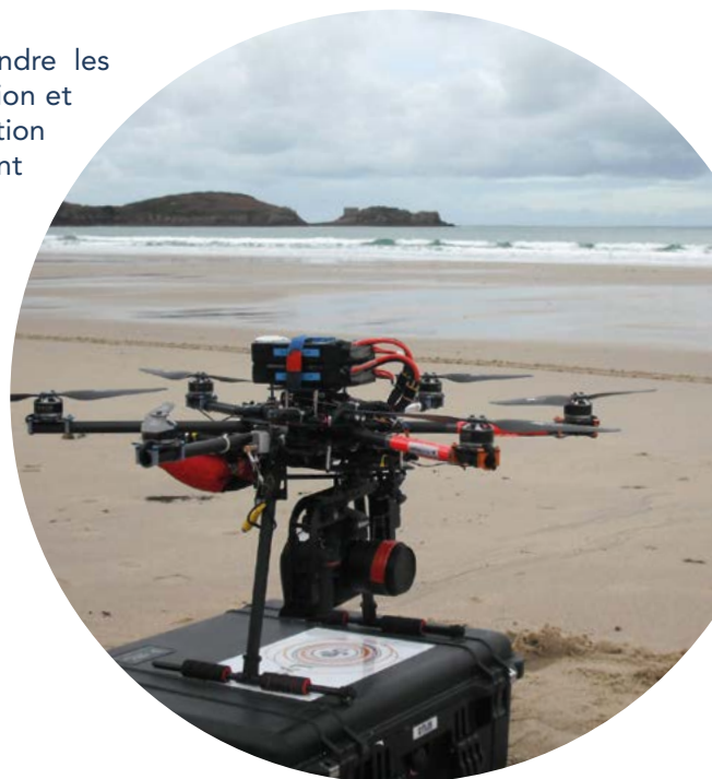
Drone multicoptère utilisé pour les levés photogrammétriques, plage de Porsmilin (Locmaria-Plouzané).
