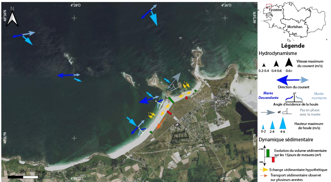
Figure 31: Carte bilan du fonctionnement hydro-morpho-sédimentaire de la plage du Vougot durant les mesures
