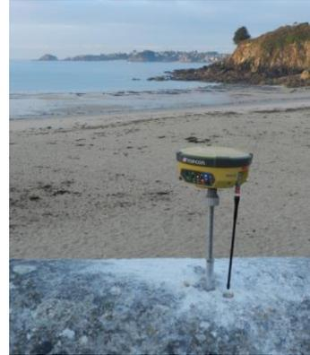
1 – Visser le support dans le mur (jusqu'en butée, mais inutile de forcer)
