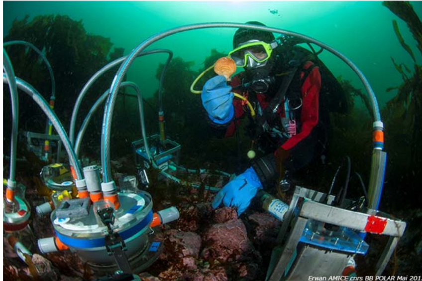
Figure 4 : Dispositif utilisé pour la mesure de la respiration et de la filtration de Chlamys islandica durant les missions de mai et septembre 2013
