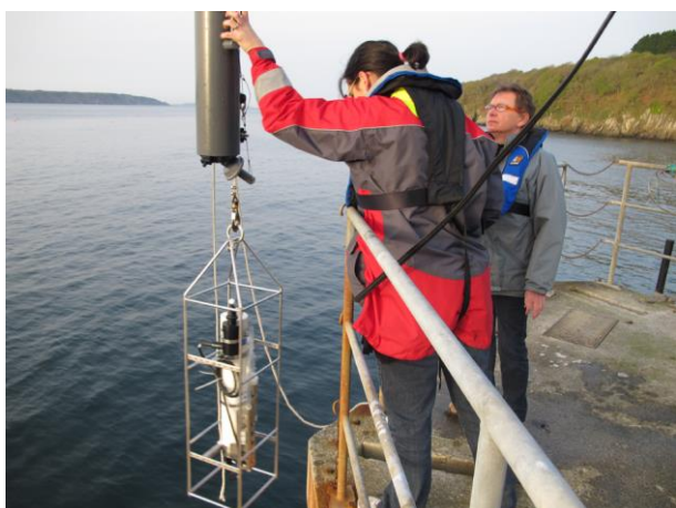
Mise à l'eau de la sonde CTD (en bas) et de la bouteille Niskin (en haut) à la station Somlit de Brest
