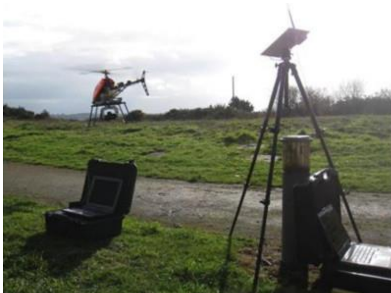
Le drone hélicoptère DRELIO lors d'un vol d'essai : la station de contrôle (à gauche) permet la programmation des vols et l'antenne GPS (à droite) la transmission des informations.
