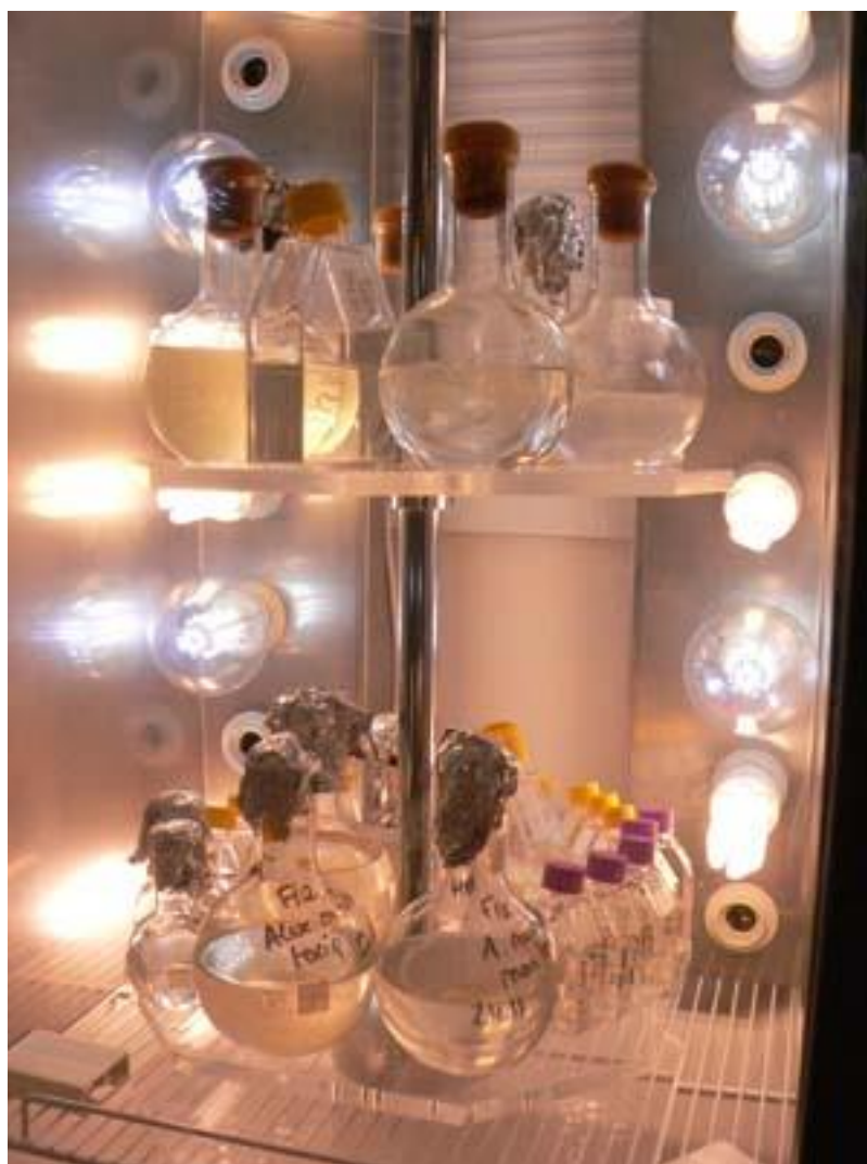
L'enceinte thermostatée de culture de phytoplancton (photo P. Pondaven)
