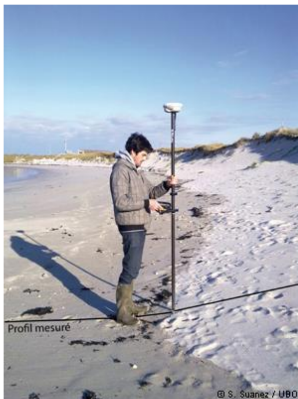
Mesure au GPS de la position et de l'altitude du runup, matérialisé par la limite entre sable sec et mouillé
