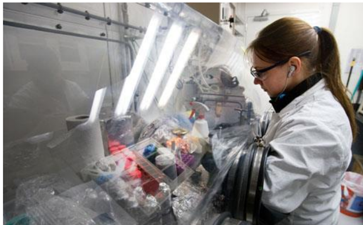
Manipulation des échantillons microbiologiques dans une enceinte stérile et anaérobie (© William Crawford, IODP/TAMU)
