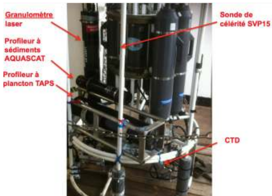
Fig. Rosette (de l'IRD) équipée avec Lisst 100, CTD, TAPS, Aquascats, SVP et 7 bouteilles Niskin
