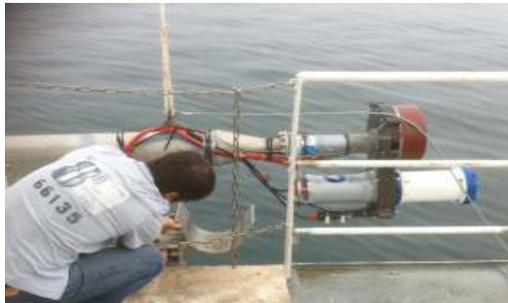
Fig. Montage du sondeur SMF EM3002, de l'ADCP WH RDI 600 et Octans Subsea III sur la perche à bâbord du N/O Antéa
