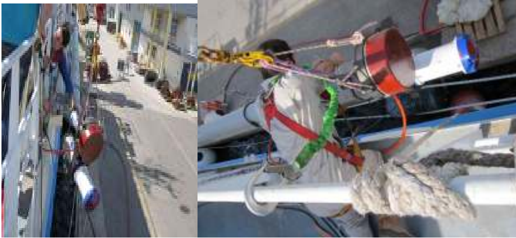
Fig. : Mise en place des instruments en bout de perche
