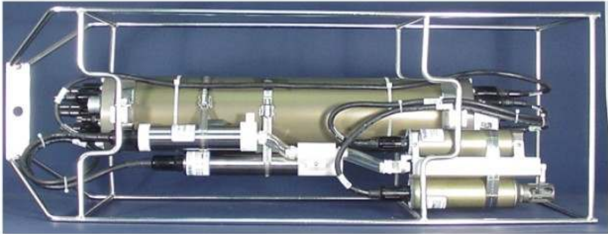
Fig. CTD Seabird 911+ utilisée sur EPURE, avec capteurs (T, C, P, O) et montée sur son châssis métallique.
