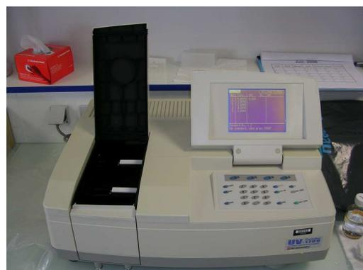
Figure 6 : Spectrophotomètre à double faisceau
