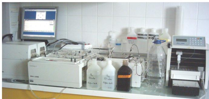
Le Technicon se compose de cinq parties : le passeur d'échantillons, la pompe péristaltique, le circuit analytique, le colorimètre et l'ordinateur (A l'aide d'un logiciel fourni par le fabricant du Technicon)
