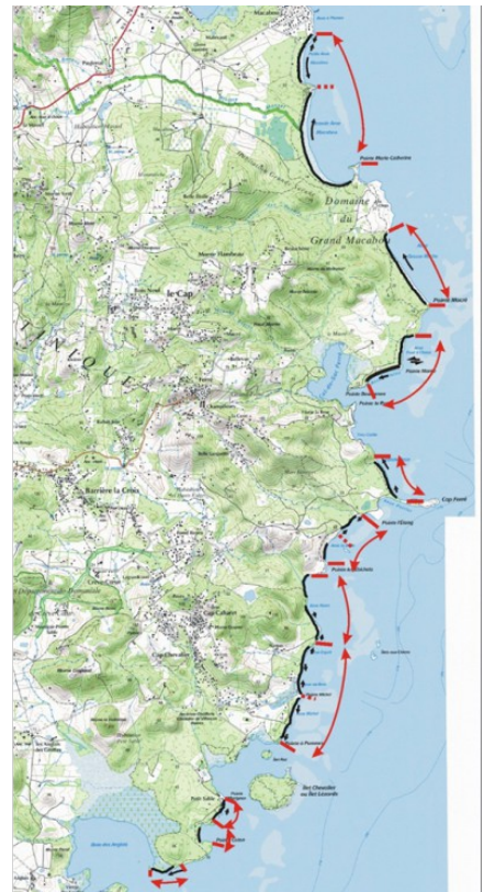
Direction du transit sédimentaire moyen lié à la houle dans chaque sous-cellule
