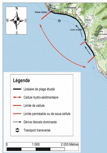
(à gauche) Evolution de la position du trait de côte entre la Pointe Lamare et Fond Canonville / (à droite) Schéma conceptuel des cellules sédimentaires et sens prédominant du transit sur le littoral de La Pointe Lamare à Fond Canonville
