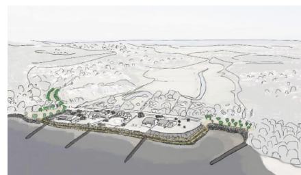
Scénario 2.3 : renforcement des ouvrages, résultat en 2050 Rallongement de la digue de front de mer depuis la maison Clémenceau. La fonctionnalité du site doit être repensée.
