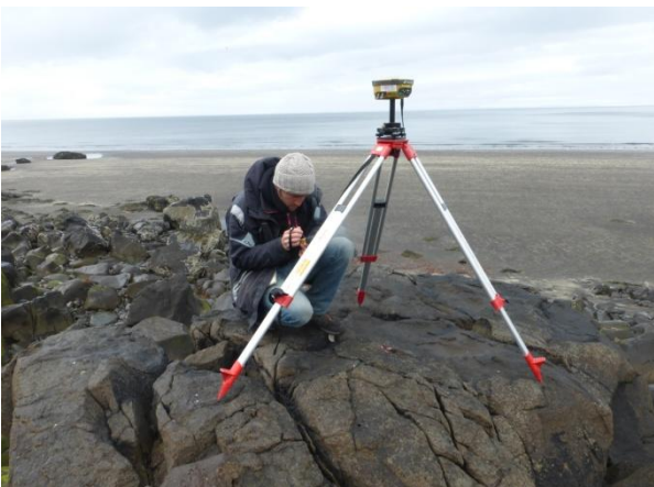
Figure 36 : Mise en place de la station du DGPS
