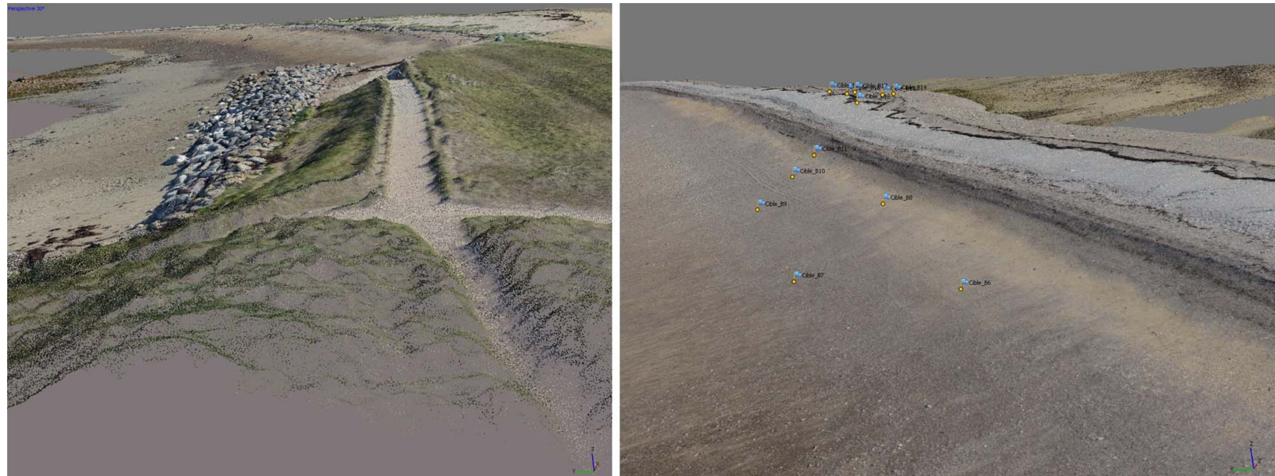
Figure 4 : Nuage dense de points topographiques obtenu à partir du traitement des prises de vues aériennes.
